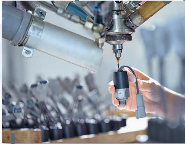
Zalévací linka na zakázkově osazené tlakové spínače pro maximální nároky kladené na stupeň krytí.
