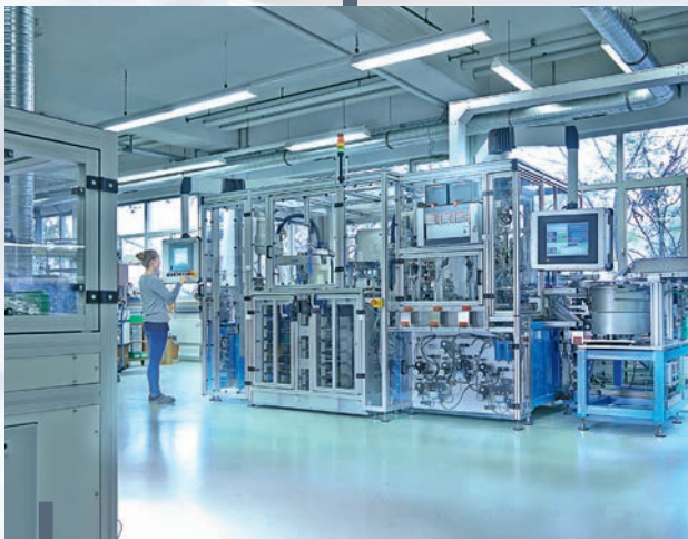
Montáž a zkoušky tlakových spínačů na poloautomatických a plně automatických linkách.
