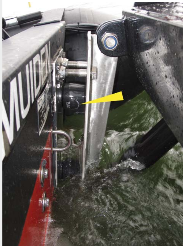
Odolné proti mořské vodě, robustní deformační tlumiče TUBUS z copolyester elastomeru umožňují bezpečné přistání pro lodě i posádky Wals Diving and marine service, 1970AC IJmuiden, Nizozemsko
