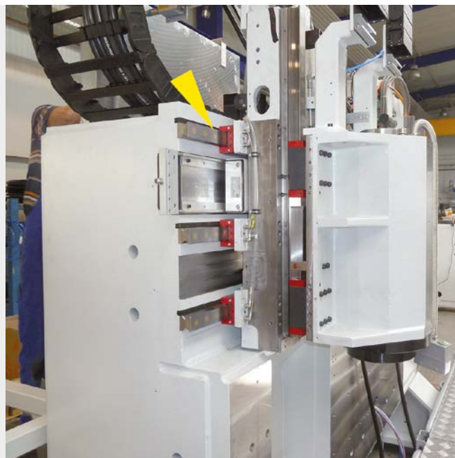
Svěrné a bezpečnostní elementy od ACE skálopevně drží osy speciálního soustruhu a zajišťují dosažené pozice jak horizontálně, tak vertikálně. RASOMA Werkzeugmaschinen GmbH, 04720 Döbeln, Německo
