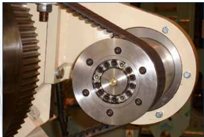
Spannsatz / Locking Assembly RfN 7012 · Zahnriemenscheibe / Belt pulley
